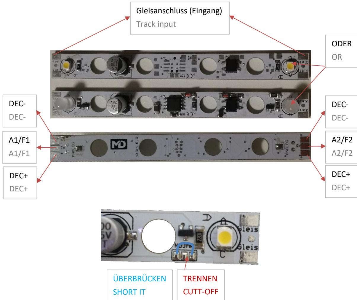
Hiermit erhalten Sie einen komplett freien Ausgang (A1) für eine Zugschlusslampe, Toilette, uvm.
