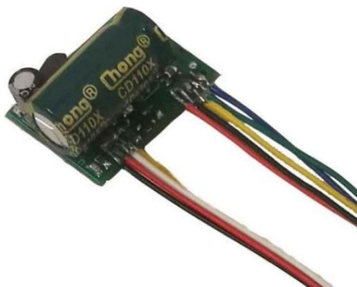
Das kleinste Soundmodul für unsere DRIVE-Lokdecoder mit SUSI-Schnittstelle mit micro X6 Kern.
